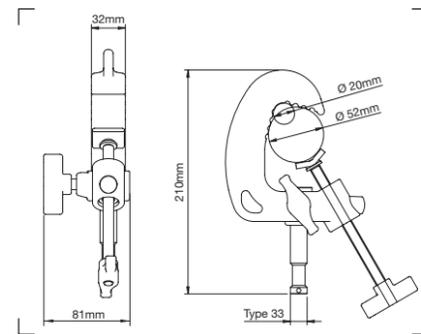
**16MM PIN QUICK ACTION BABY CLAMP C338**
